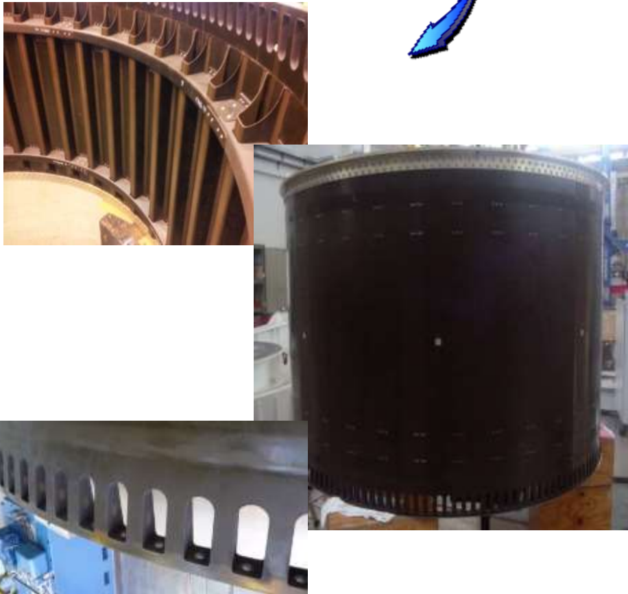
Estructuras monolíticas con refuerzos co-curados
